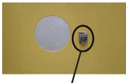
LAN utičnica na toplotnoj pumpi iPump – gornji pokrivač/panel
